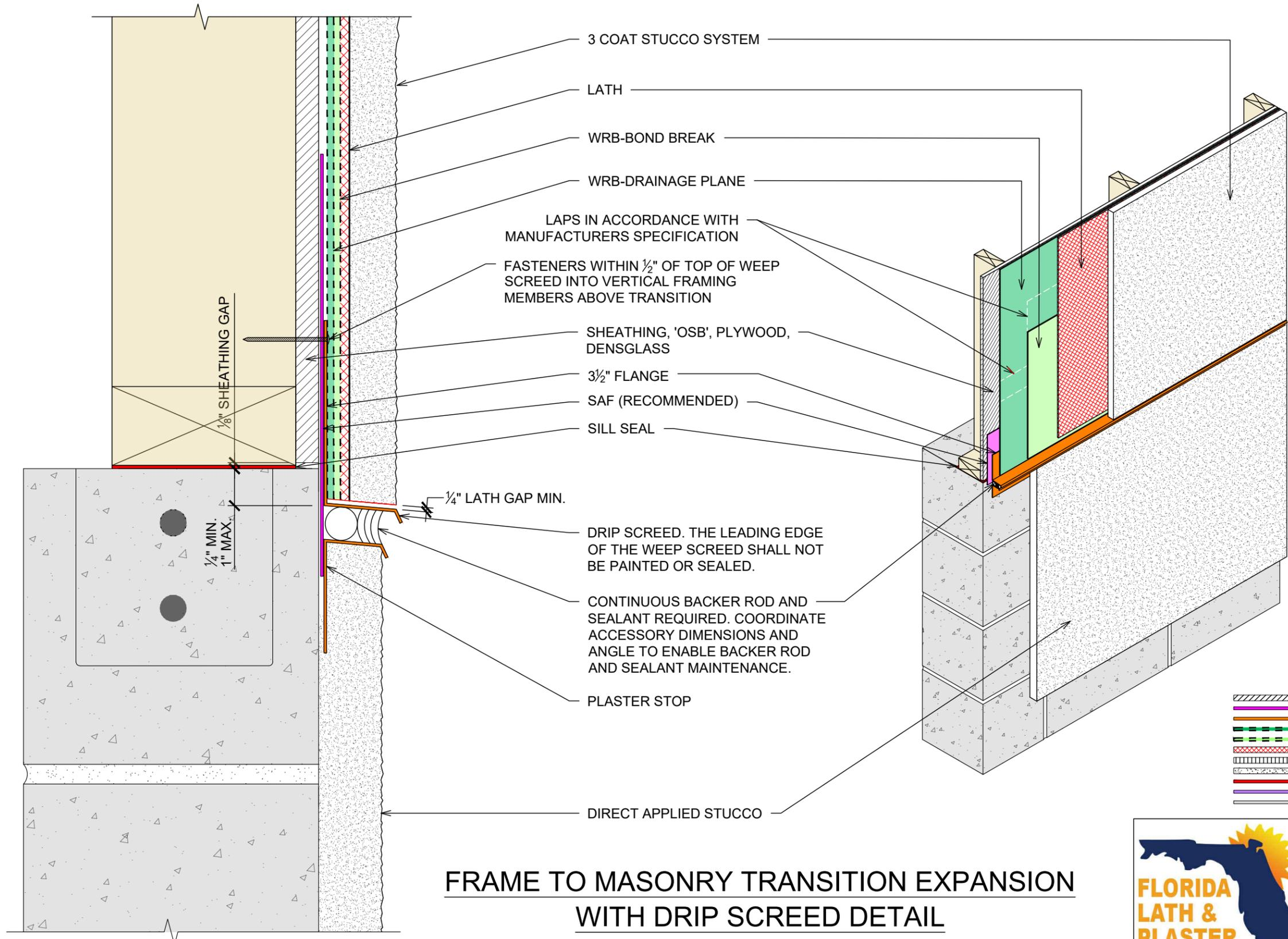
**FRAME TO MASONRY TRANSITION EXPANSION
